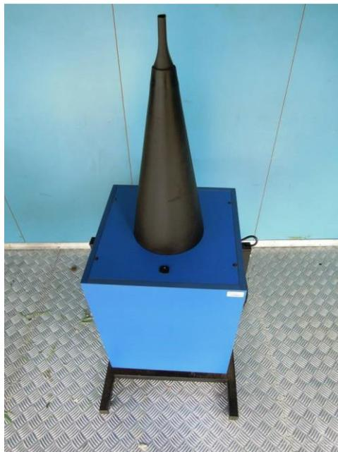
Figura 23 - Cone soprador
